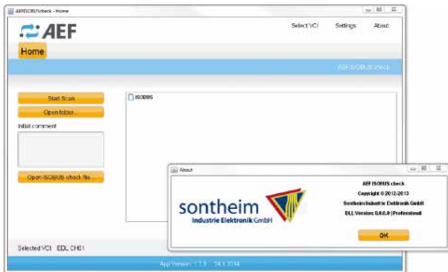
Bild 2: Das ISOBUS Check Tool zeichnet wichtige Diagnoseinformationen der verschiedenen ECUs auf dem Bus auf.
